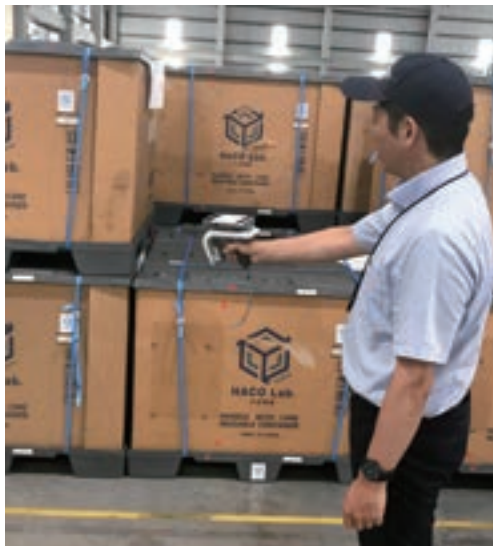
RFIDタグを一気にスキャン 開封前に内個数の確認が可能
